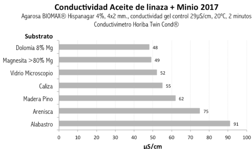
Fig. 4.65. Conductividad de las películas pictóricas de aceite de lino con minio sobre los sustratos de las probetas.
