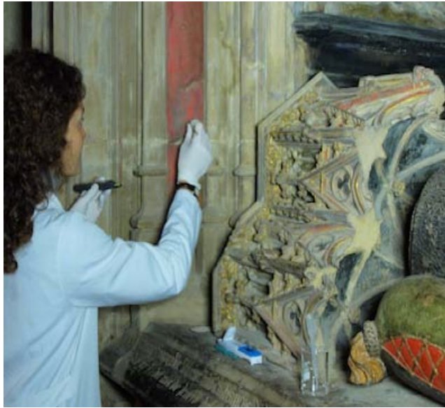
Fig. 2.4. Medición de pH y conductividad de la superficie. Sepulcro de Villaspesa 1420-1422, Catedral de Tudela (Navarra, España). © Gobierno de Navarra.
