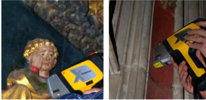
Fig. 4.41. Zona en la que se hizo estudio elemental mediante fluorescencia de rayos X tanto en las policromías del Sepulcro de Villaspesa como en su entorno.
