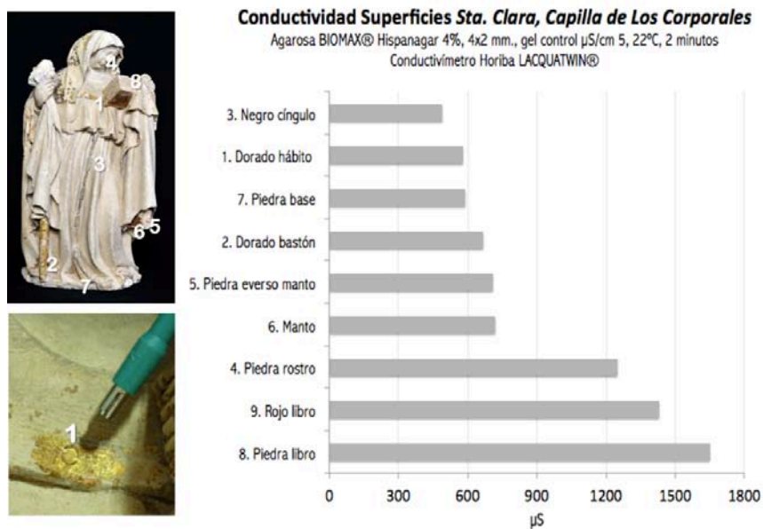
Fig. 4.59 Medición de la conductividad de diversos puntos de la superficie de la escultura de Santa Clara de la Capilla de los Corporales de la Iglesia de Santa María de Daroca, España. 1417-21.
