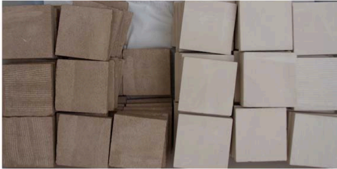
Fig. 4.8. Probetas de piedra arenisca y caliza preparadas para ser policromadas con las diversas películas pictóricas al óleo.
