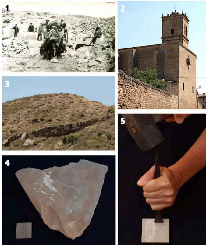
Fig. 4.7 (1, 2, 3, 4 y 5). Extracción y labra de la arenisca de Pitillas. (1.) Extracción de roca en cantera en los años 30 del siglo XX 34 . (2.) Paramentos de mampostería en la iglesia parroquial de Pitillas (Navarra). (3.) Afloramiento de estratos de arenisca en las antiguas canteras de Pitillas. (4.) Fragmento de roca y probeta de 6x6x1 cm cortada y preparada para el experimental de la tesis. (5.) Texturizado de la superficie de la probeta de roca de Pitillas con una gradina.
