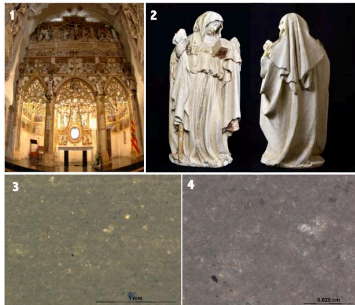
Fig. 4.18 (1, 2, 3, 4). Microfotografías a diversos aumentos y con nicóles cruzados y paralelos de la lámina delgada de la caliza micrítica procedente de Villanueva de Huerva (Zaragoza). (1.) Capilla de los Corporales, Colegiata de Santa María de Daroca (Zaragoza); (2) Sta. Clara procedente de la Capilla de los Corporales c. 1417-21. (3y4) Se caracteriza una roca esencialmente compuesta de Calcita con un 25% de arcilla. © Francesca Gambino y Alessandro Borghi.
