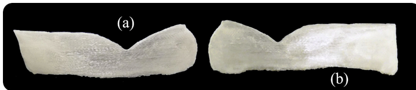
Figura B.30: Resultado del tratamiento superficial con vapores de acetona en la impresión 3D del implante 2 del objeto Plato : (a) exterior, (b) interior.
