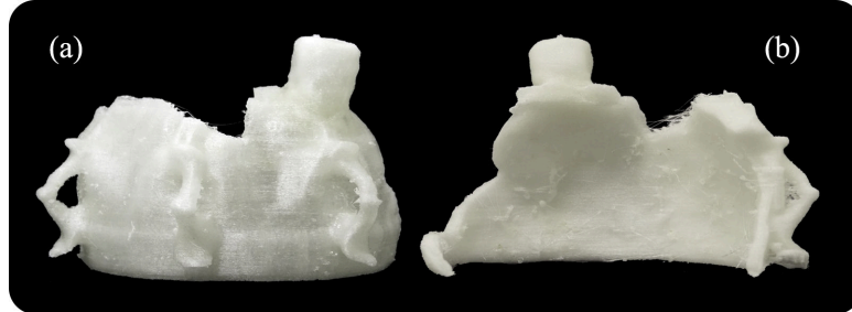
Figura 5.12: Resultado de la impresión 3D con la orientación horizontal-frontal del implante 1 del Cuenco 1 con el filamento translúcido ( Clear ): a) exterior, (b) interior.
