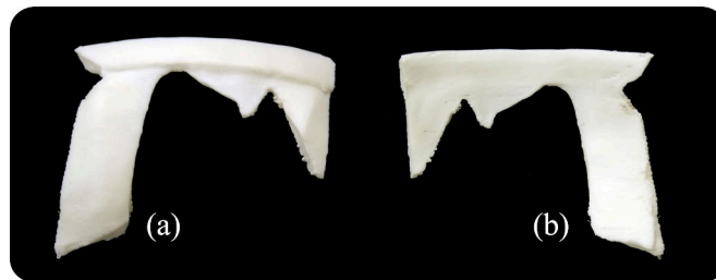
Figura B.5: Resultado del tratamiento superficial de abrasión en seco sobre del implante 1 del objeto Cuenco 2 : (a) exterior, (b) interior.
