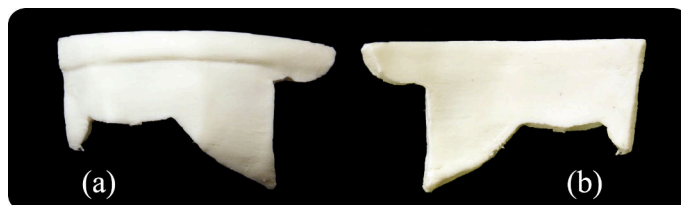
Figura B.8: Resultado del tratamiento superficial de abrasión en seco sobre del implante 2 del objeto Cuenco 2 : (a) exterior, (b) interior.
