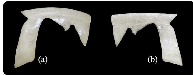
Figura B.21: Resultado del tratamiento superficial con vapores de acetona en la impresión 3D del implante 1 del objeto Cuenco 2 : (a) exterior, (b) interior.
