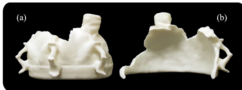
Figura 5.11: Resultado de la impresión 3D con la orientación horizontal-frontal del implante 1 del Cuenco 1 con el filamento blanco ( White ): (a) exterior, (b) interior.
