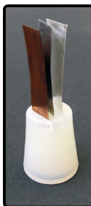
Figura 8.52: Tapón de silicona con los tres metales para el Oddy test. De izquierda a derecha: cobre, plomo y plata. Los metales se introducen en unas ranuras practicadas en el interior del tapón, quedando las tiras lo suficientemente separadas para no entrar en contacto.
