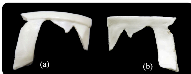
Figura B.6: Resultado del tratamiento superficial con vapores de acetona en la impresión 3D del implante 1 del objeto Cuenco 2 : (a) exterior, (b) interior.
