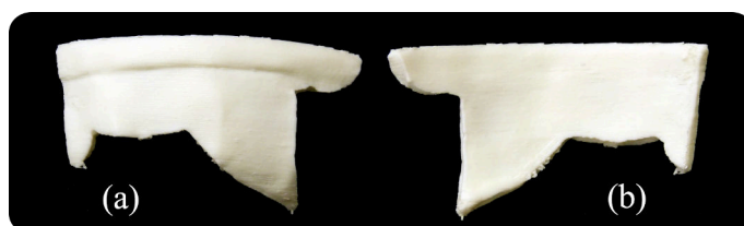
Figura B.7: Resultado de la impresión 3D del implante 2 del objeto Cuenco 2 : (a) exterior, (b) interior.
