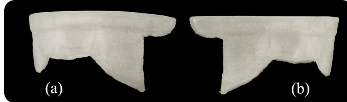
Figura B.23: Resultado del tratamiento superficial de abrasión en seco sobre el implante 2 del objeto Cuenco 2 : (a) exterior, (b) interior.
