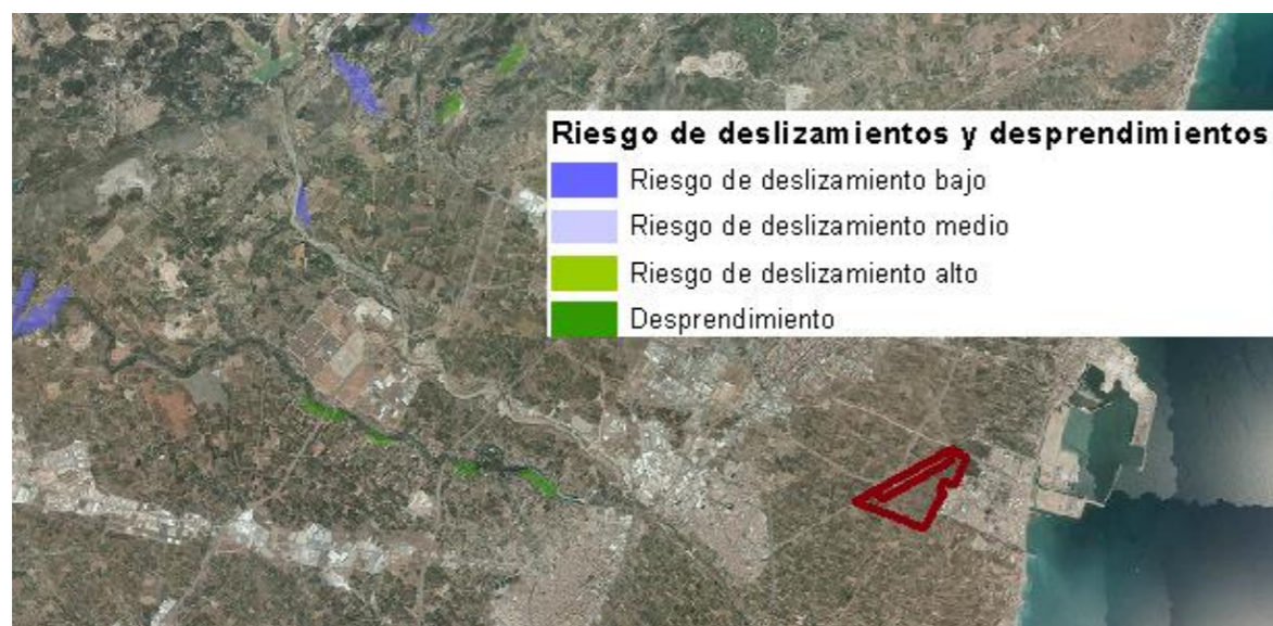
Ilustración 112. Riesgo de deslizamiento y desprendimientos en el entorno de la Alternativa 2.
