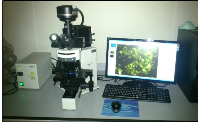
Figura III.44: Microscopio OLYMPUS BX50F utilizado en los ensayos con lámpara de mercurio de alta presión 100-W
