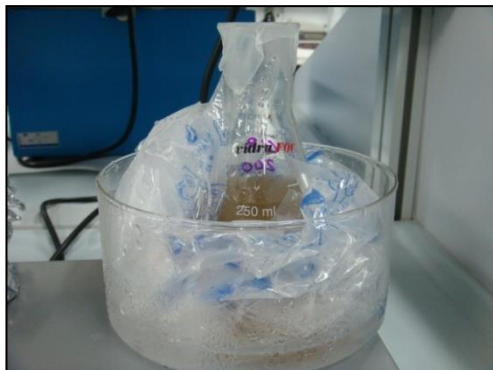
Figura III.21: Proceso de extracción de EPS mediante la resina CER
