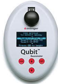
Figura III.41: Fluorómetro utilizado para la determinación del ADN
