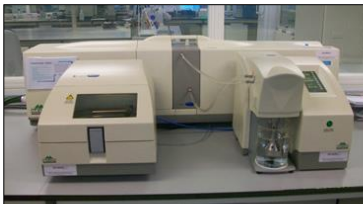
Figura III.14: Equipo de medición del tamaño de partículas. Mastersizer 2000
