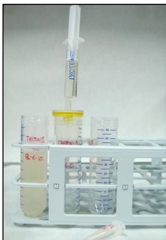
Figura III.22: Filtración del extracto previo al almacenamiento a -20^{\circ}\text{C}
