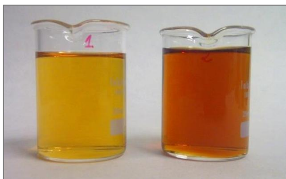
Figura IV.51: Aspecto de la corriente de permeados obtenidos tras la ultrafiltración del licor de mezcla del MBR-LS (izqda.) y MBR-HS (drcha.)
