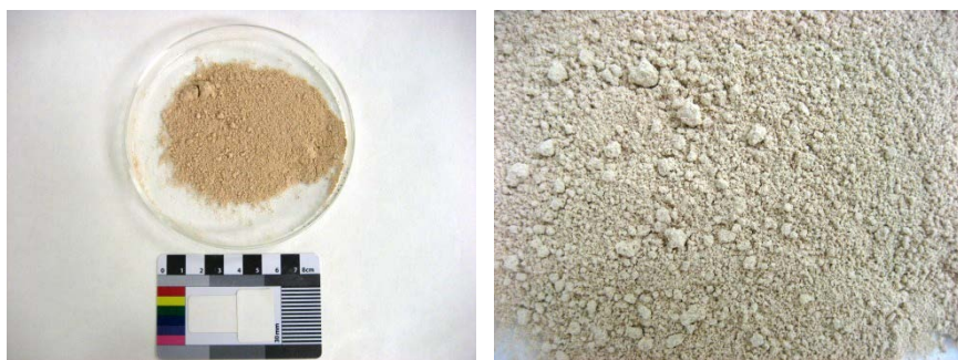
Img. 350: Aspecto de la fracción recogida en el tamiz de luz de malla inferior a 0.063 mm de la Muestra 2
