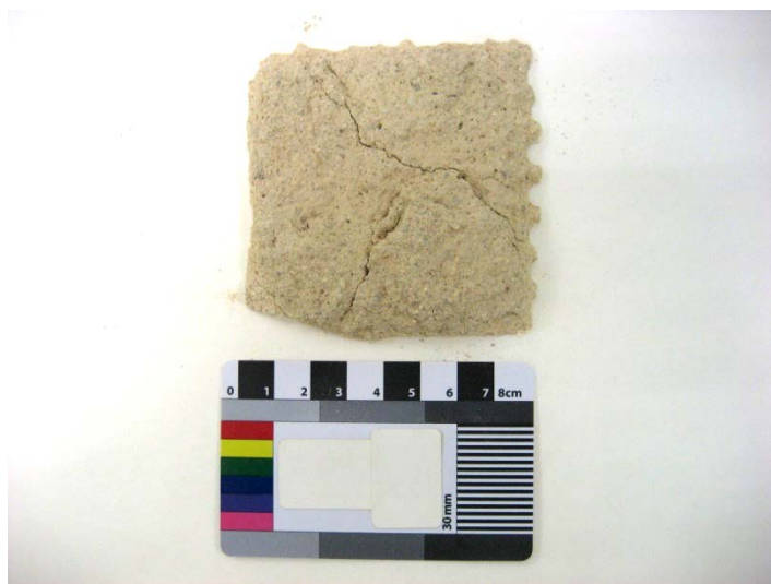
Img. 343: Muestra M3. Enfoscado continuo de mortero de cal.
