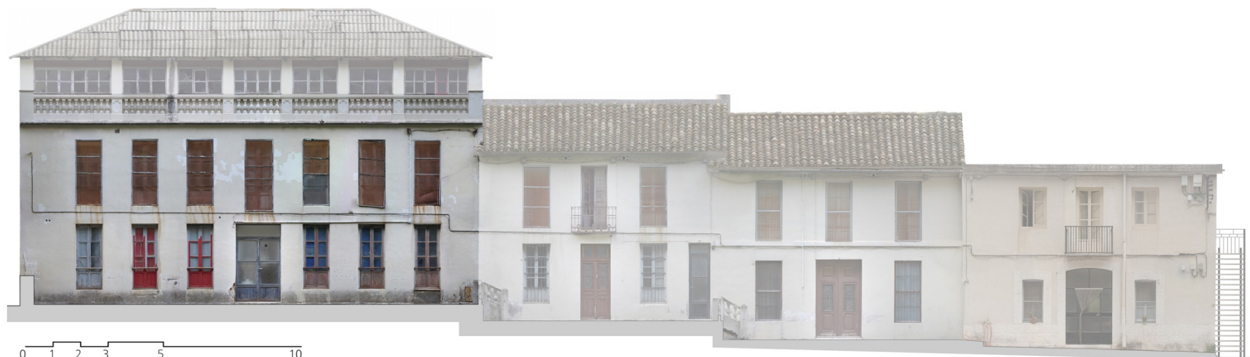
Fig. 90: Fotoplano conjunto de Viviendas de Entrada. Resaltada 3ª Fase (1930-1932). Viviendas de Personal y Servicios. Escala gráfica.
