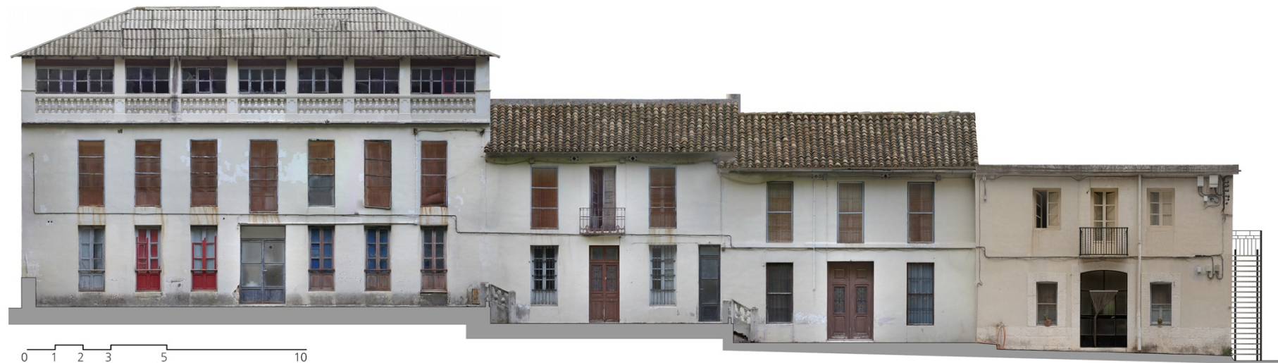
Fig. 82: Fotoplano del conjunto de Viviendas de la Entrada. Estado actual. Escala gráfica.
