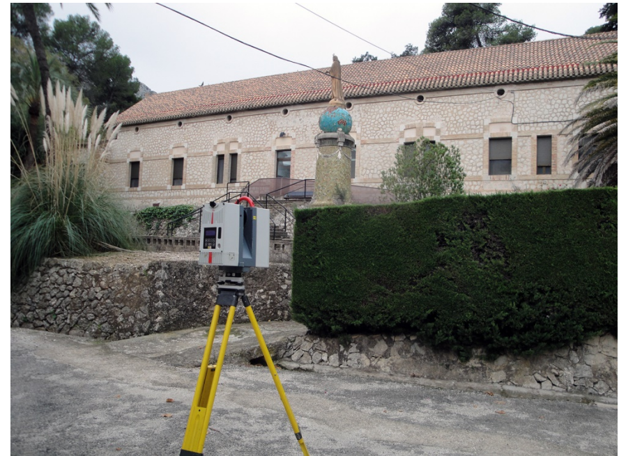
Img. 6: Metodología de levantamiento mediante el apoyo de Laser Scann, desarrollado en el marco del proyecto.
