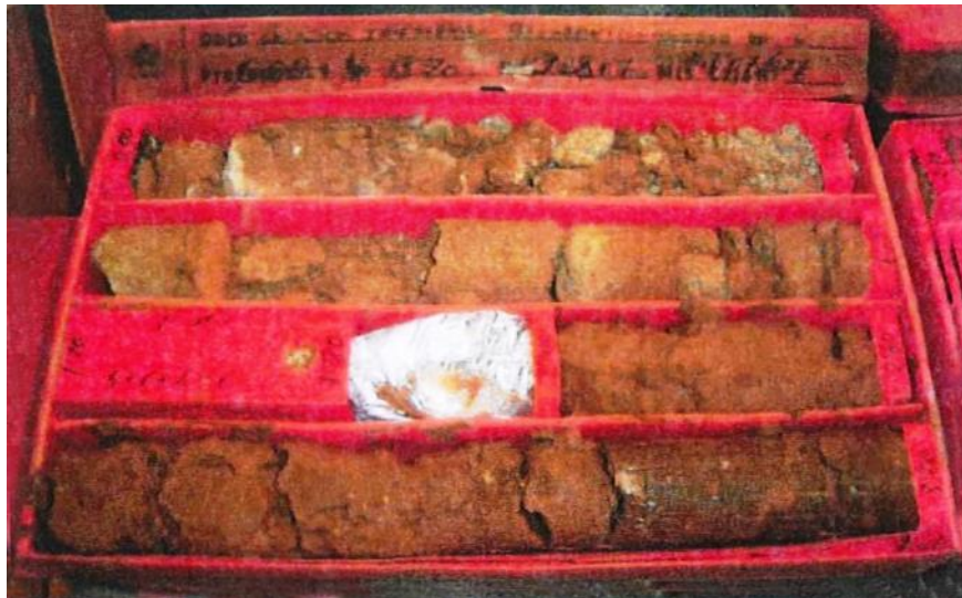
Img. 286: Estratigrafía del terreno. Sondeo rotativo. Nivel 1 (0.0 a 3.2 m).
