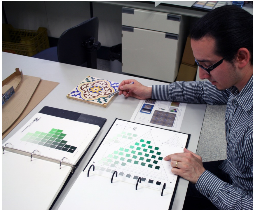
Img. 327: Comprobación visual del color mediante Carta NCS (Natural Color System).
