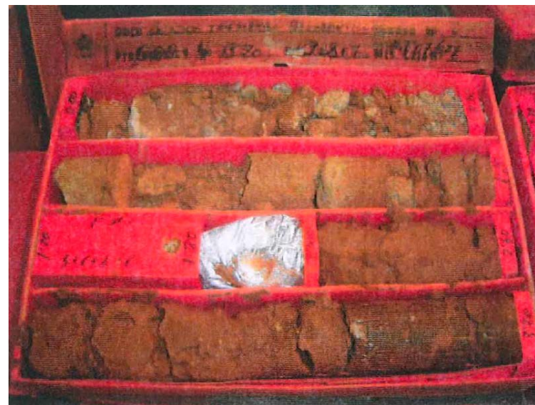
Img. 357: Sondeo Rotativo nº 3. Enfermería de Mujeres. Nivel 1 (0.00-3.20m).
