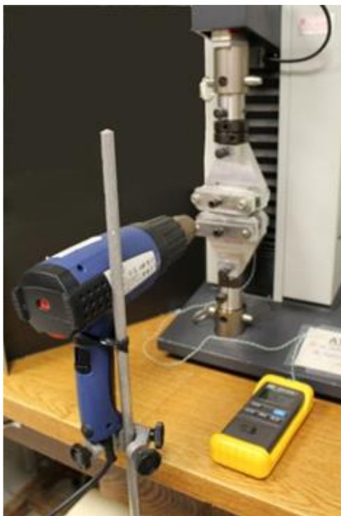
Figura 26. Ensayo de tracción de imanes a distintos rangos de temperatura. (Fotografía y edición M.Azahara Rodríguez).
