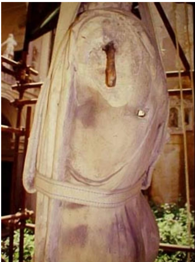
Figura 2. Imagen que muestra el perno de hierro de corte cuadrangular en el brazo izquierdo de una de las esculturas de mármol del Palacio Lancellotti. (Fotografía extraída de Materials and techniques used in the 17th century restoration of sculptures from the antiquities collection of the palazzo Lancellotti ai Coronari. 13 p).
