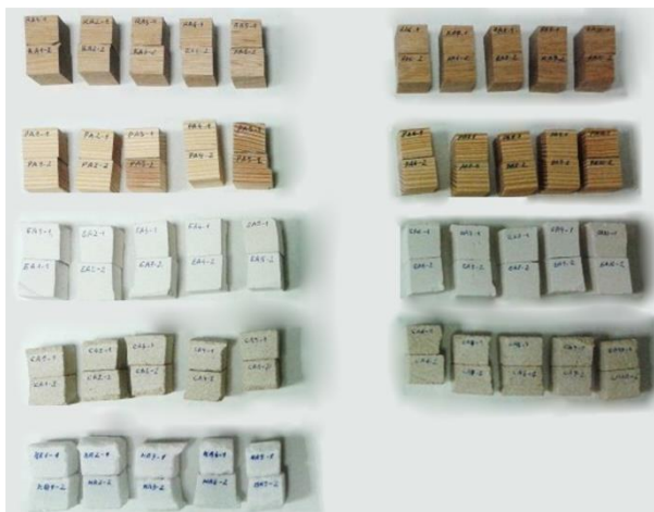
Figura 27. Algunas de las probetas con los adhesivos aplicados antes del ensayo de tracción. (Fotografía y edición M.Azahara Rodríguez).
