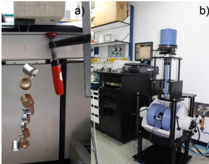
Figura 35. Ensayos realizados sobre ceras magnéticas. a) Ensayo de tracción con pesas. b) Ensayo en VSM. (Fotografía y edición M.Azahara Rodríguez).
