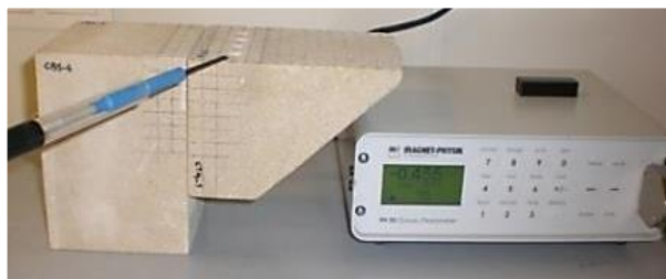
Figura 31. Mediciones de campo magnético con sonda. (Fotografía y edición M.Azahara Rodríguez).
