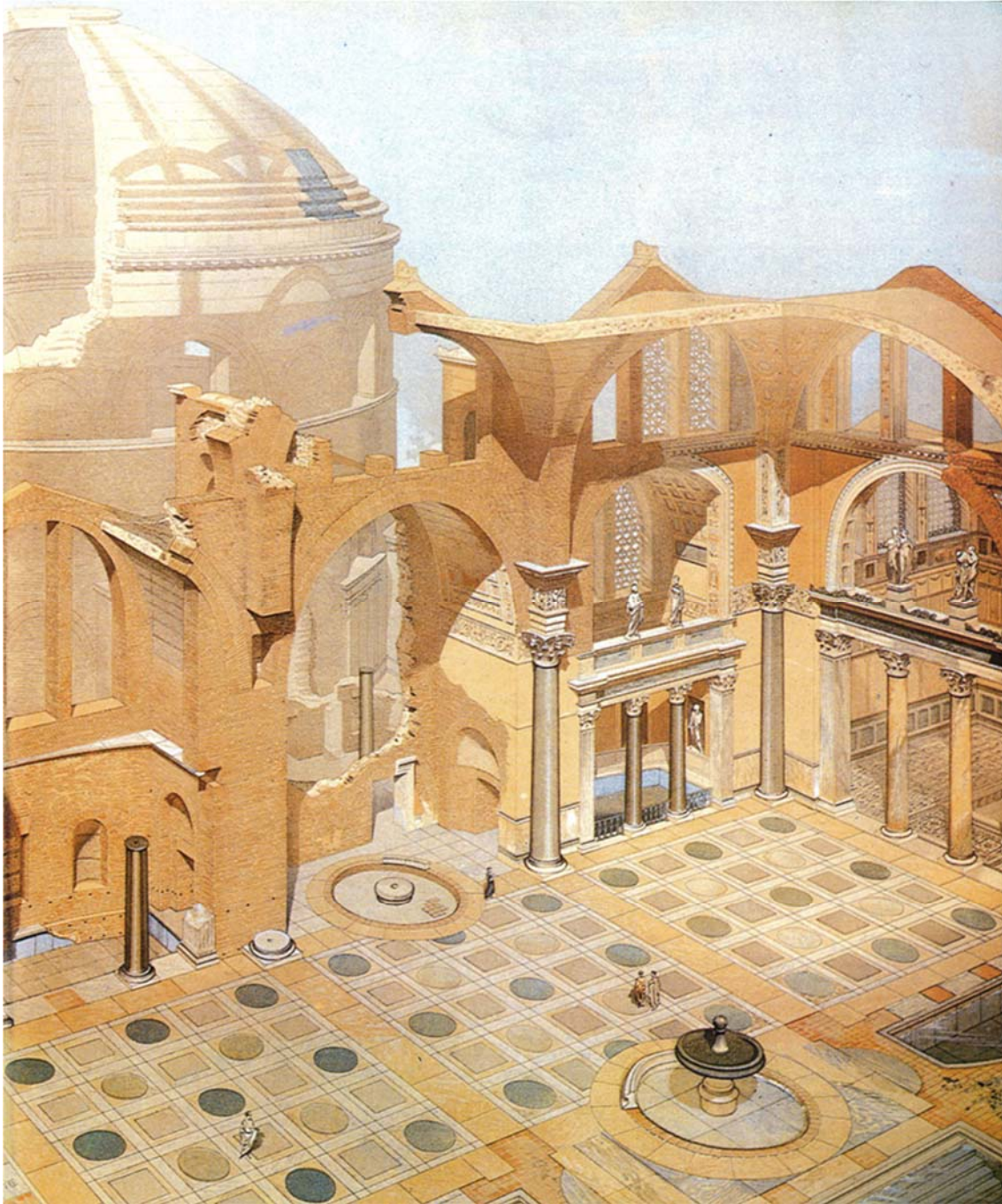
Ilustración 6. Acuarela de Viollet-le-Duc, en la que realiza un análisis de la estructura de una therma romana para los estudiantes de la École spéciale d'architecture (1867).
