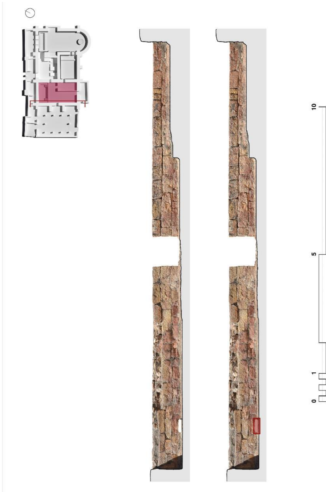
Ilustración 118. Fotoplano correspondiente al alzado SO de la sala del apodytherium , frigidarium desde la cota del terreno. La zona sombreada corresponde a las reconstrucciones realizadas en la última intervención.
