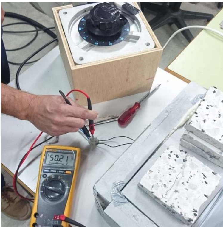
Ilustración 262. Ajuste de la potencia que se va a introducir en la lámina.
