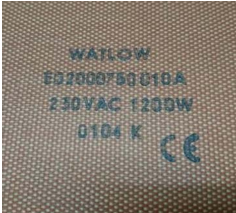
Ilustración 261. Detalle de las especificaciones de la lámina de la resistencia eléctrica utilizada.
