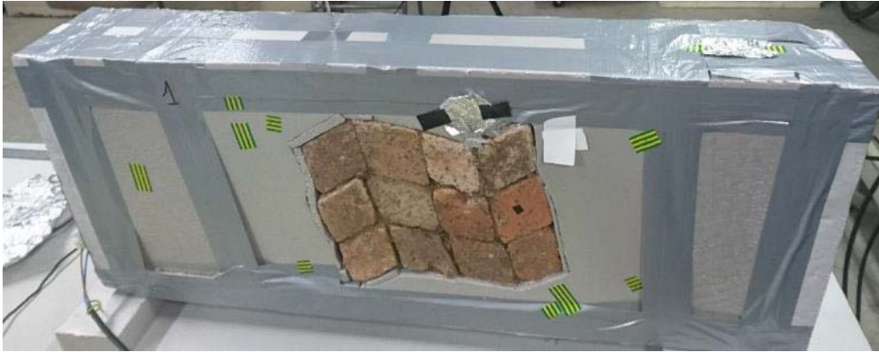
Ilustración 271. Imagen visual sobre la probeta en la que se indican los puntos de medición sobre los que se obtiene las temperaturas y emisividades.
