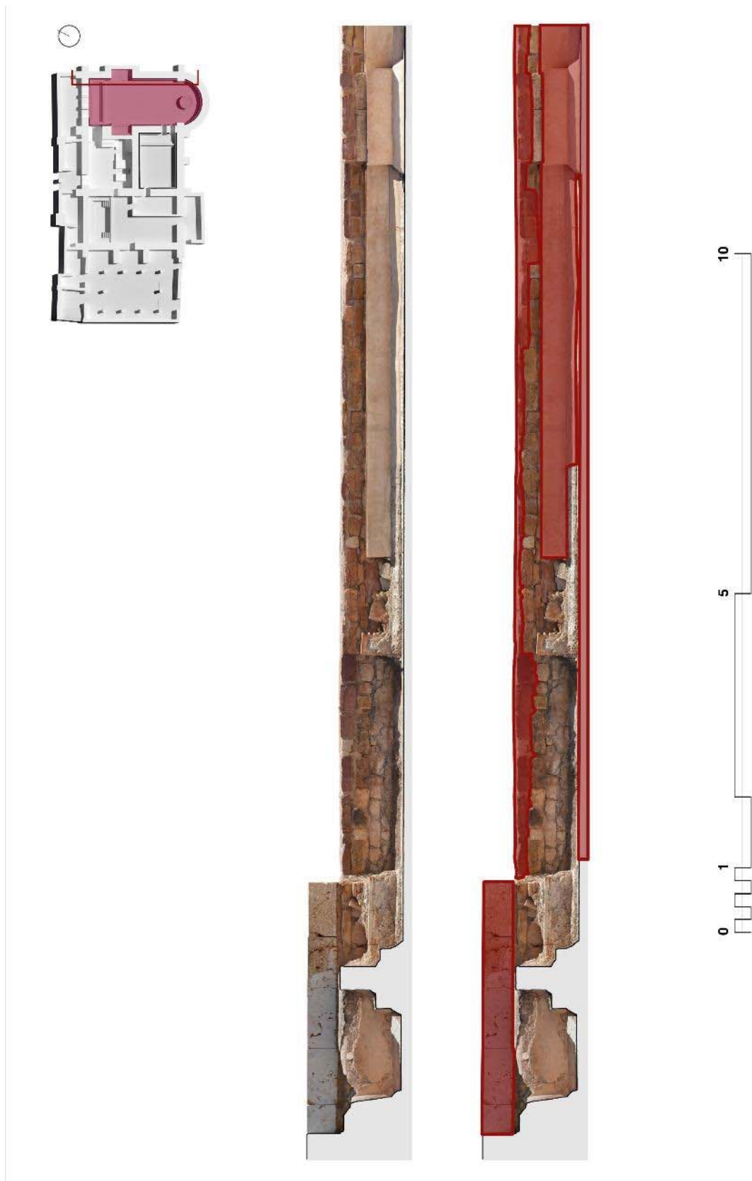
Ilustración 137. Fotoplano correspondiente al alzado NE de la sala del caldarium desde la cota del terreno. La zona sombreada corresponde a las reconstrucciones realizadas en la última intervención.
