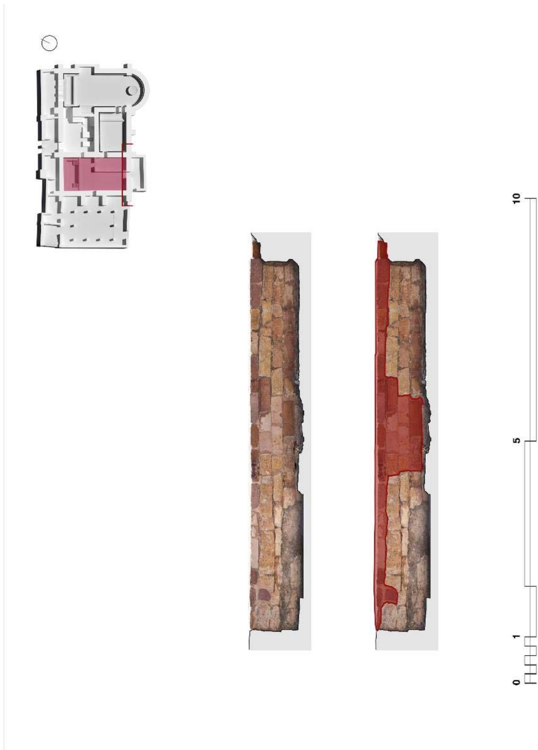
Ilustración 117. Fotoplano correspondiente al alzado SE de la sala del apodytherium , frigidarium desde la cota del terreno. La zona sombreada corresponde a las reconstrucciones realizadas en la última intervención.
