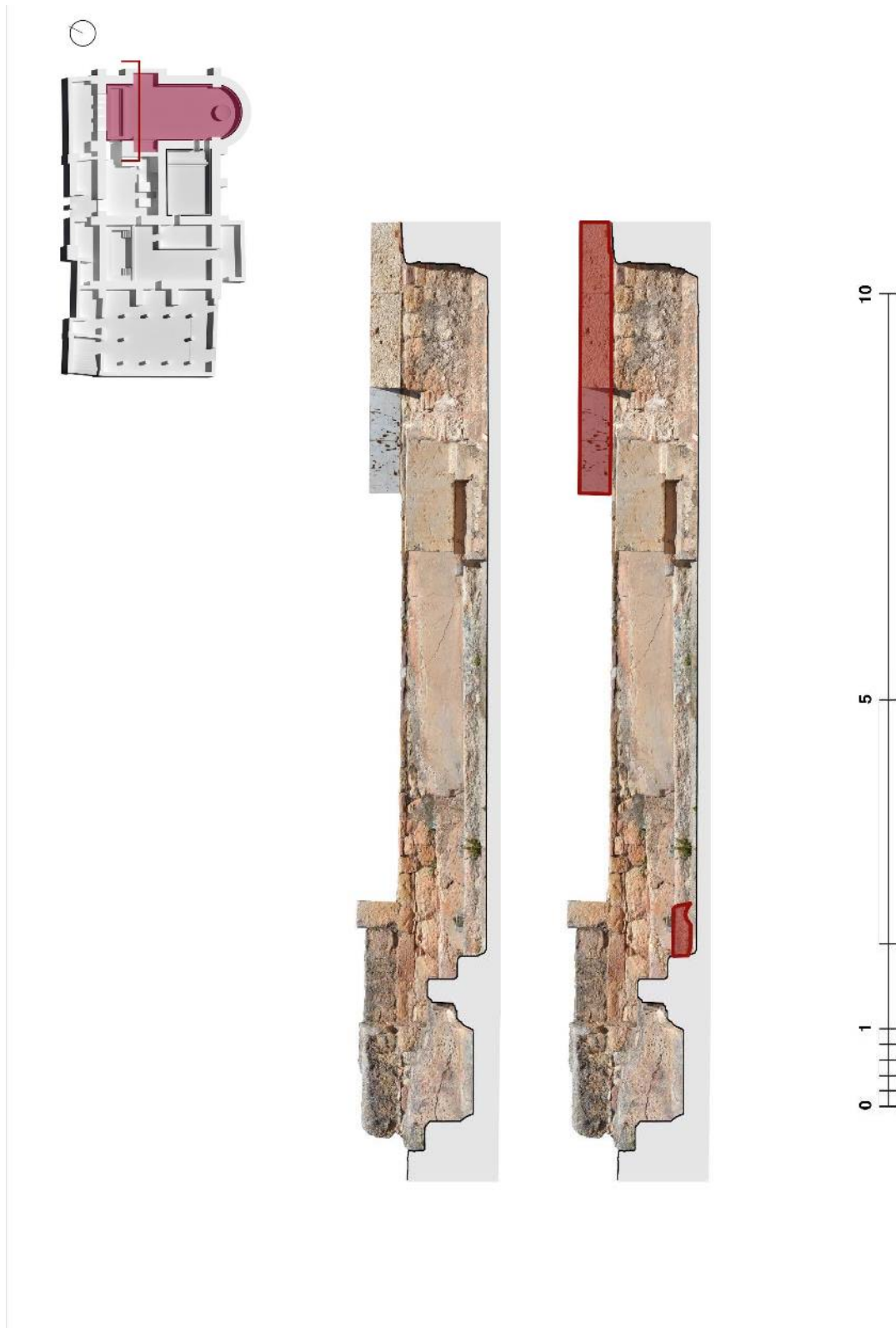
Ilustración 138. Fotoplano correspondiente al alzado NO de la sala del caldarium desde la cota del terreno. La zona sombreada corresponde a las reconstrucciones realizadas en la última intervención.
