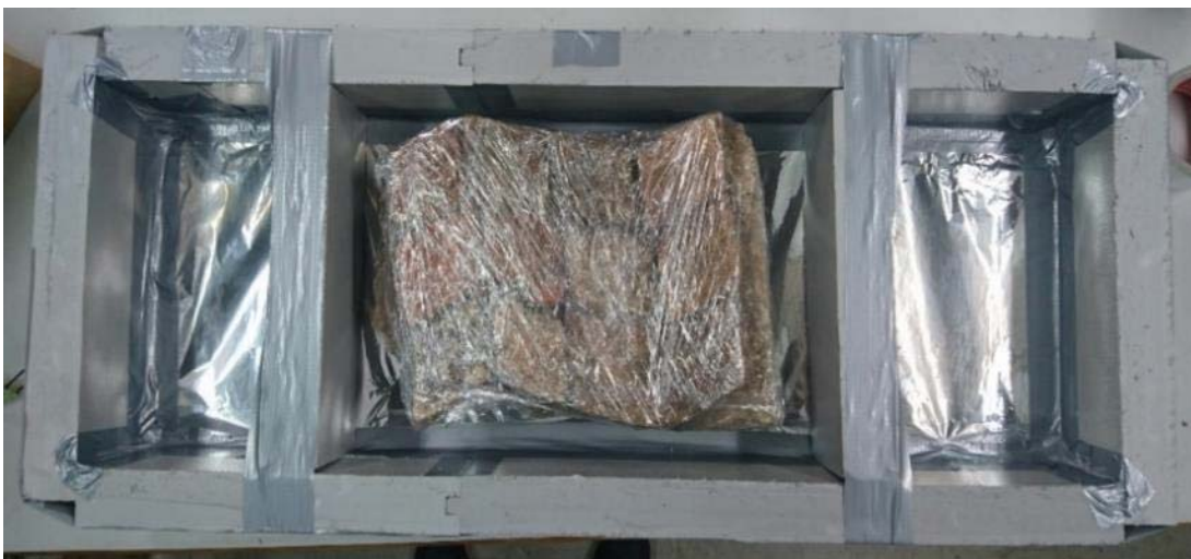
Ilustración 264. Detalle del aislamiento de la pieza.
