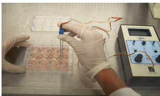
Figura 11. Medición de la resistencia eléctrica transepitelial. La medida de las monocapas en sistemas Transwell® se realiza empleando un voltímetro Millicell®-ERS.
