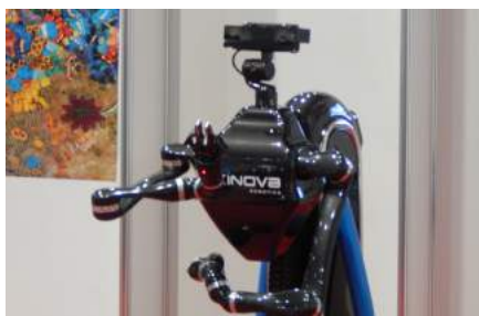
Foto tomada en la competencia de robótica “RoboCup 2016” en Leipzig, Alemania. Muestra al robot de servicio de la empresa Kinova Robotics. No ha competido en la RoboCup, se encontraba haciendo una demostración de venta para los equipos que competían. Los brazos manipuladores son lo mejor del robot, combinan ligereza y precisión -es su mejor característica-. Al ser un robot que asista a los humanos, no desarrollaron la parte de interacción humano-robot como el trabajo que se realiza en el laboratorio de bio- robótica de la UNAM.
