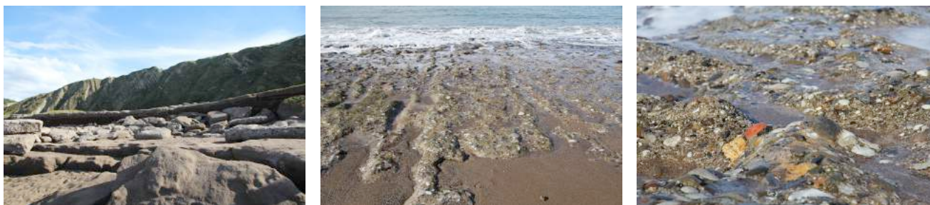
Figura 3. Playa cementada de Gorrondatxe, Bizkaia, País Vasco; a) vista general en la que se puede apreciar el desnivel existente entre los dos grupos de estratos que componen la playa principalmente; b) fotografía de los depósitos conglomeráticos cementados del estrato inferior; c) detalle en el que se pueden observar los diferentes tipos de escorias que conforman los depósitos, entre ellos fragmentos de ladrillo refractario.
