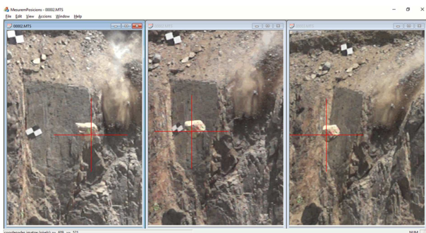
Figura 2: Una muestra de nuestro programa en el que vemos la medida simultánea de un punto sobre el bloque desde tres puntos de vista distintos.
