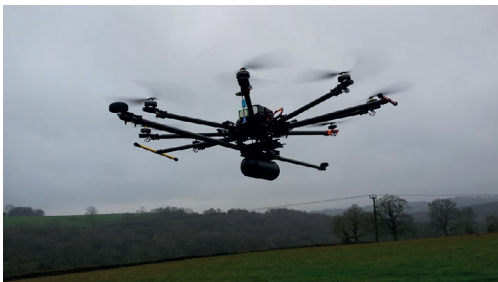
Figura 2. Sistema LIDAR “TerraSystem-LidarPod” aerotransportado en un Octocóptero
