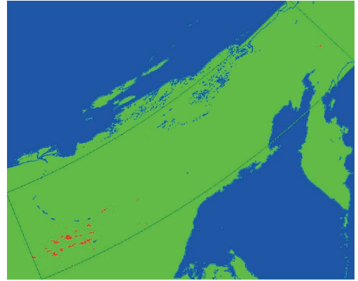
Figura 2. Mapa de área quemada del año 2002 de la región boreal de Siberia NE obtenidos a partir del conjunto de datos LTDR. Interpretación de los colores: rojo: quemado, verde: no quemado, azul: agua.
