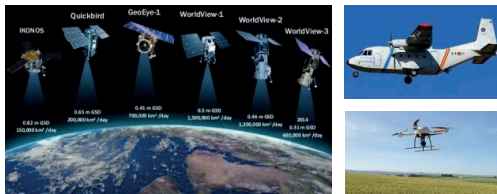
Figura 5. Ejemplo de plataformas de teledetección de interés para la vigilancia de ecosistemas: satélites de alta resolución, plataforma aeroportada (INTA) y dron.
