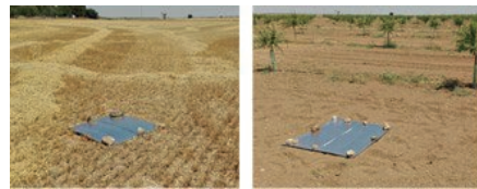
Figura 3. Ejemplo de paneles reflectantes de Aluminio de 1 m 2 sobre las parcelas de cebada (izquierda) y almendro (derecha).
