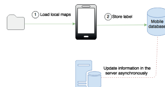
Figura 2. Esquema de funcionamiento de la app Android.
