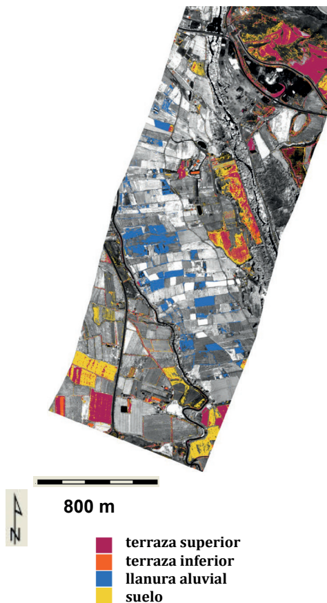
Figura 2. Mapa de formaciones geológicas cartografiadas en una llanura aluvial de sedimentos detríticos predominantemente carbonatados extraído de imágenes AISA Eagle II.
