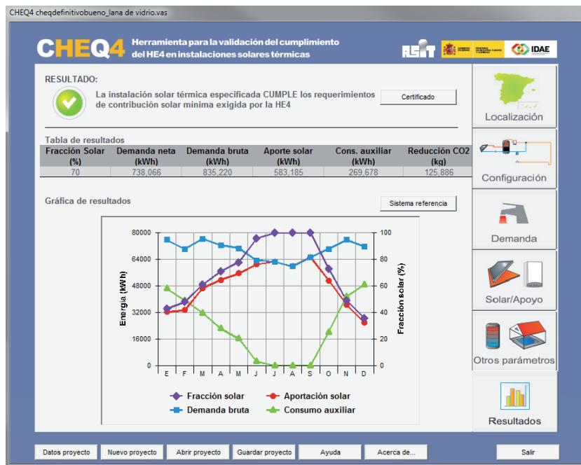
Figura 40. Certificación de la instalación mediante CHEQ4.2 [15].
