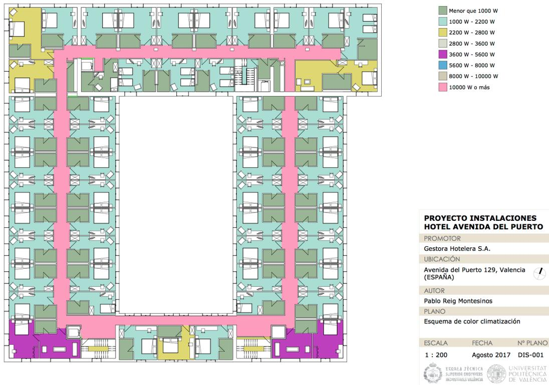
Imagen 4.2. Esquema cargas de climatización por espacio
