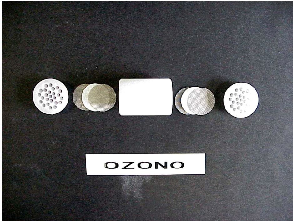
Figura 3.2: Dosímetro de ozono. A) Dosímetro de ozono desmontado. De izquierda a derecha: tapón de polipropileno con 24 perforaciones de 1,5 mm, malla de acero inoxidable (0,3 mm de paso de malla), filtro de fibra de vidrio impregnado con la solución captadora, cuerpo de polipropileno, y a continuación otra vez las partes mencionadas en orden inverso.
