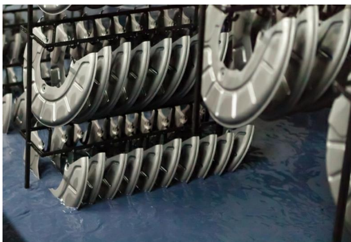
Figura 7: Piezas en la etapa de fosfatado por inmersión. Fuente: Pincasa
