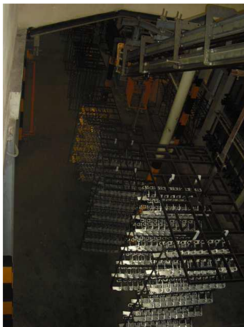
Figura 6: Zona cuelgue/descuelgue bastidores en la línea de tratamiento por cataforesis Fuente: Pincasa
