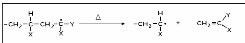
Figura 23. Proceso de despolimerización.
