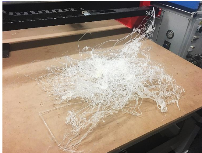
Figura 50. Polímero resultante del proceso de extrusión.
