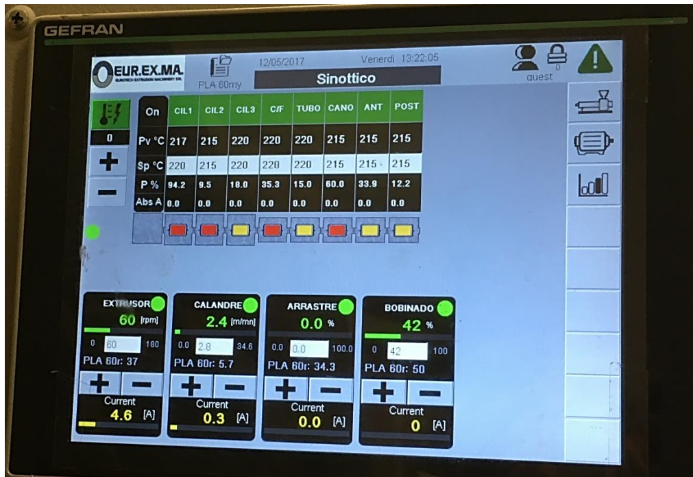
Figura 53. Parámetros utilizados en el equipo.
