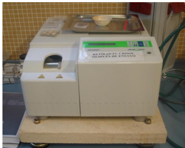
Figura 56. Equipo ensayo TGA tipo TGA/SDTA 851.
