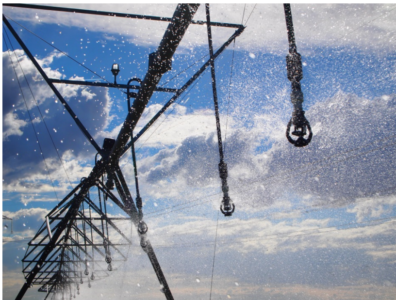
Figura 4: Pivote con emisores I-Wobs de baja presión (6 psi).
