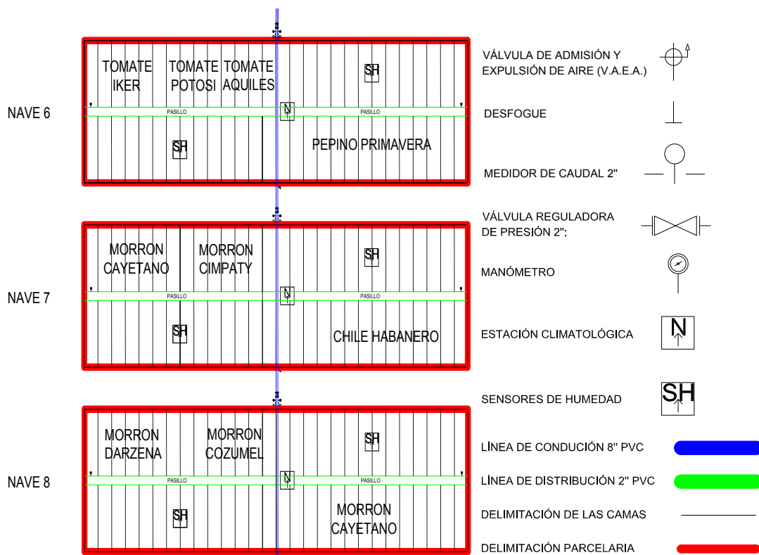
Figura 4. Esquema de la instalación del equipo y distribución de los cultivos.
