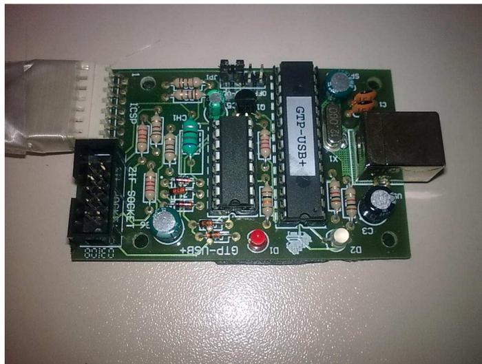
**Figura 13: Programador GTPLite**
