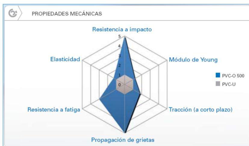
**Figura 8** Comparativa propiedades mecánicas del PVC-o vs al PVC-U
