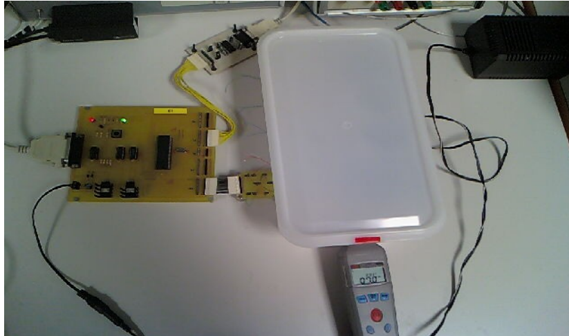
Figura 46. Sistema complet mesura sensors capacitius
