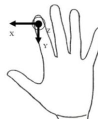
**Figura 10. Orientación de los ejes del acelerómetro.** Esta figura representa la posición del MPU6050 en el guante y la orientación de los ejes en los que se produce la medida.
