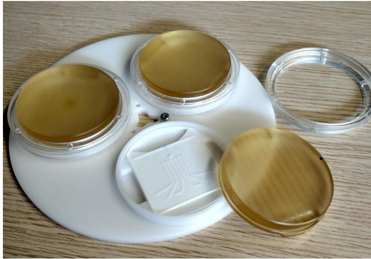
Fig. 41 Moldes empleados para la fabricación de la leveling layer
