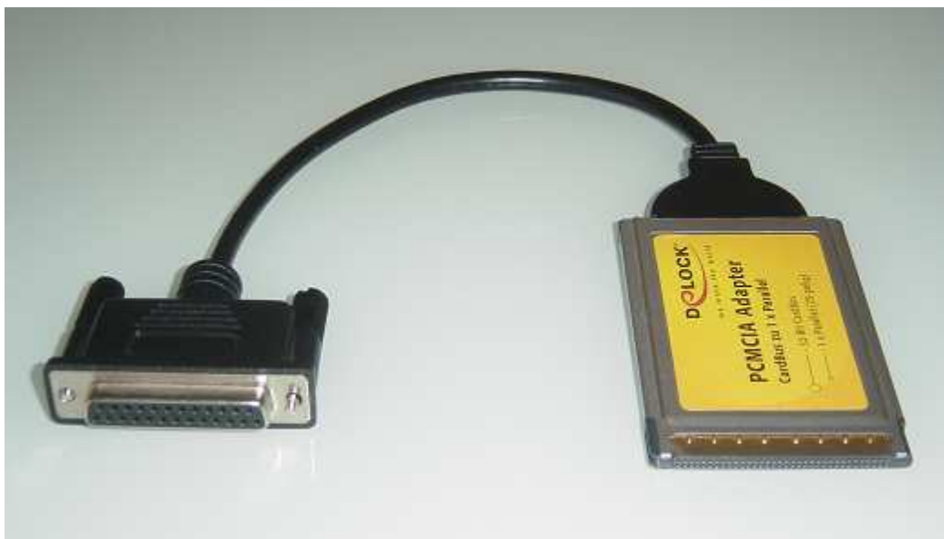
Fig. 6. 1 Tarjeta PCMCIA a puerto paralelo
