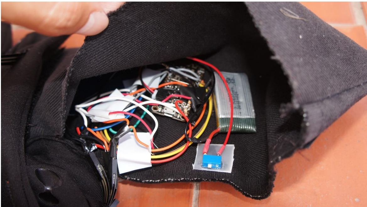
Figura 2.10 – Conexiones del guante de control
