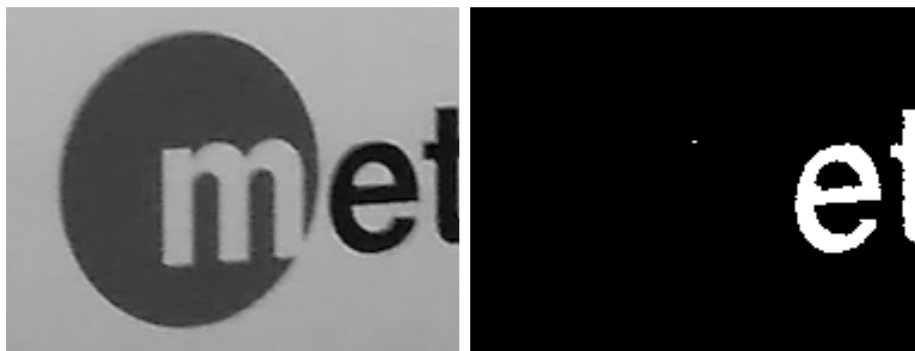
Figura 3. Binarización de imagen con umbral fijo invertido.
