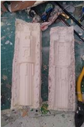
Pieza de silicona solidificada sin extraer del molde
