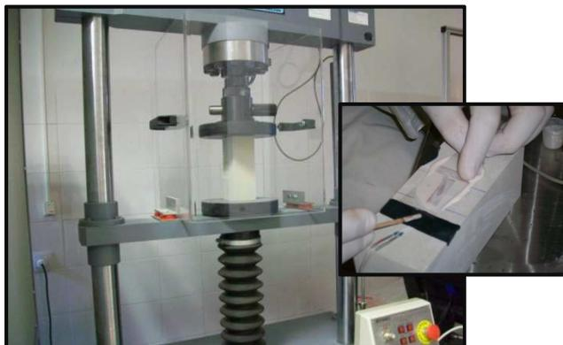
**Figura 3.** Prensa multiensayo y detalle de la aplicación de la galga extensométrica
