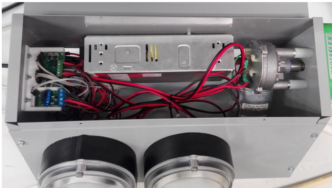
Figura 64. Interior del módulo de bombas.
