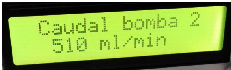
Figura 51. Menú de modificación del caudal de la bomba 2.
