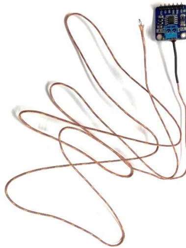
Figura 21. Termopar tipo K con acondicionador MAX31855.
