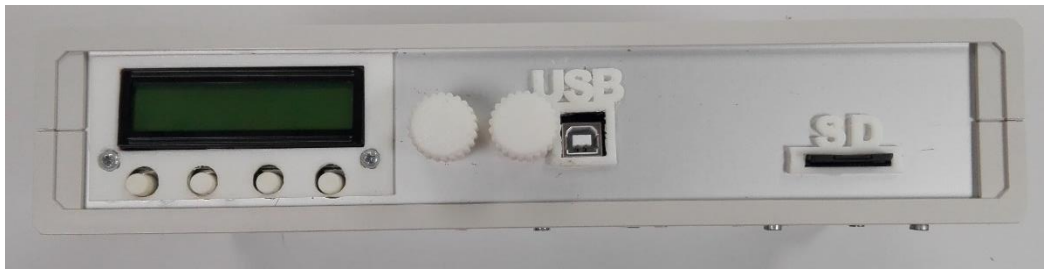
Figura 60. Parte frontal del módulo de control.
