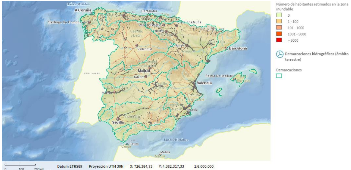
Ilustración 2. Mapa de riesgo inundación fluvial afección a población T=100 años. (Fuente: MAPAMA)
