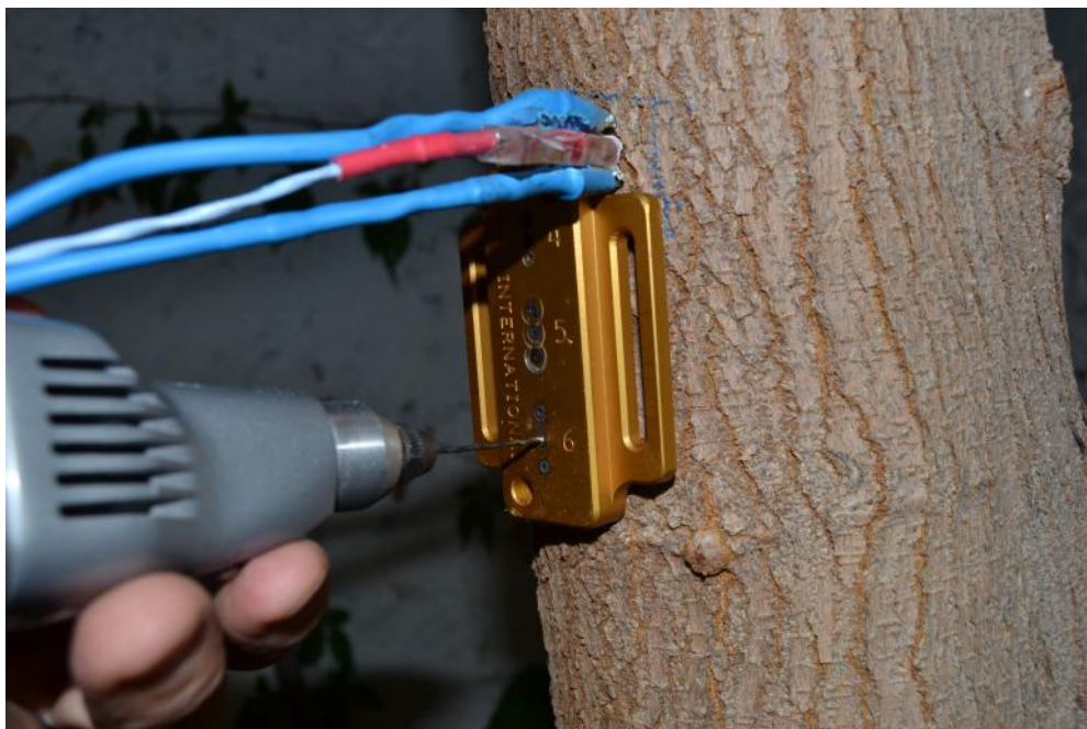
Ilustración 10.- Ejecución de los taladros a través de la placa guía.
