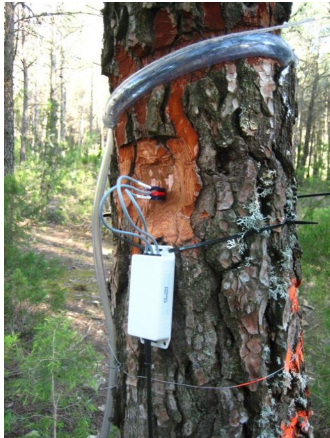
Ilustración 2.- Detalle de la instalación de los sensores de flujo de savia en campo
