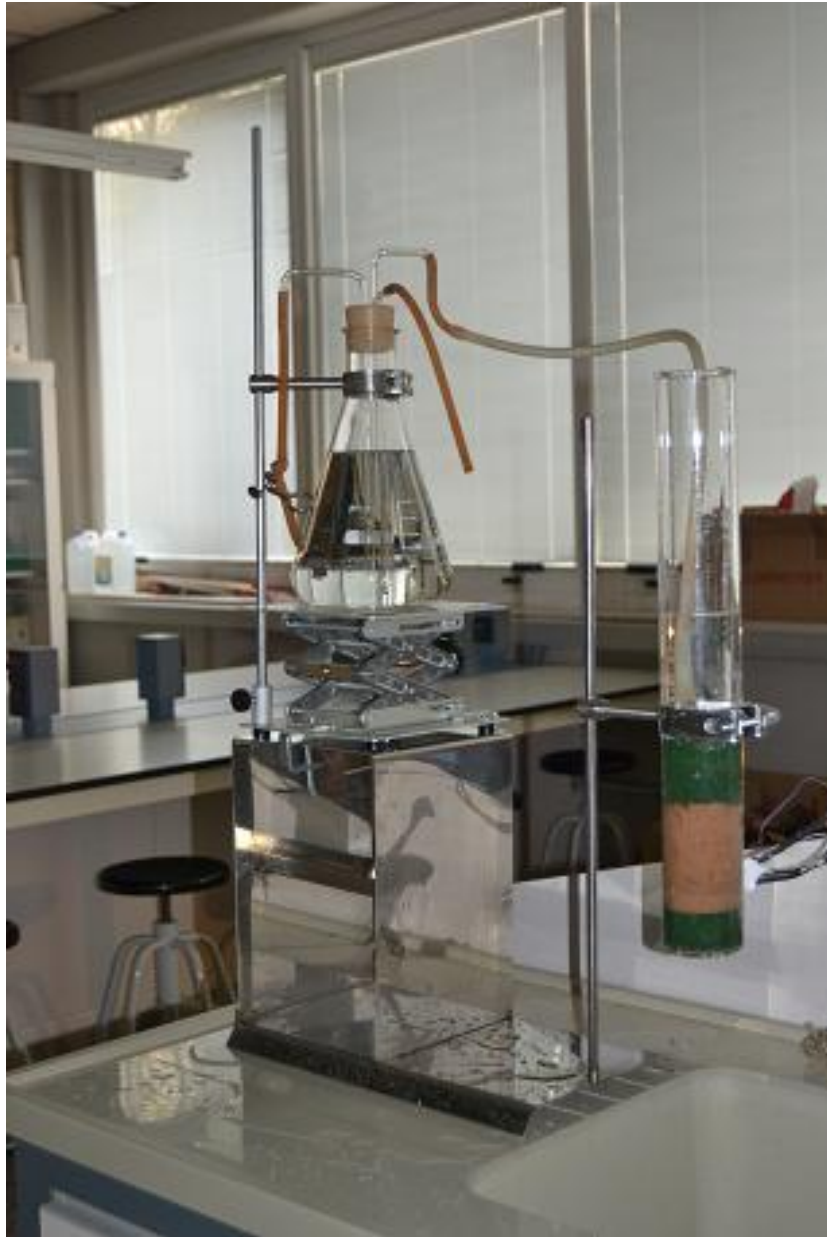
Ilustración 7.- Botella de Mariotte utilizada en la calibración de los equipos. En el tubo de metacrilato transparente se aprecia un sustrato formado por serrín de haya confinado entre corcho verde.
