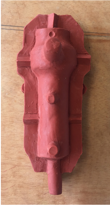
Fig. 46: Camisa de plastilina con tabique divisor y llaves, respiraderos y bebedero.
