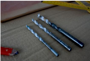
41. Brocas de Widrias utilizadas. Del num 6, 8 y 10
