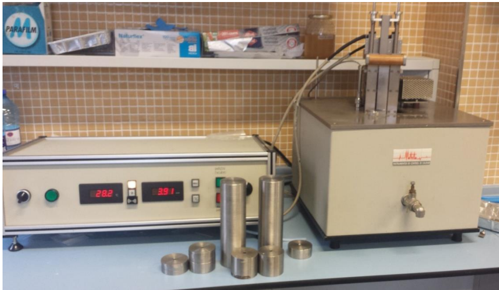
Figura 28 Estación de medida de temperatura Vicat y HDT
