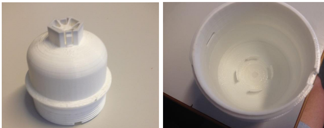
Figura III.15. a) Imagen exterior de la carcasa impresa mediante la impresora Prusa b) Imagen de la parte interior de la carcasa fabricada mediante la impresora Prusa
