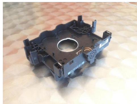
Figura III.2. a) Imagen de la pieza original de la carcasa del mando elevelunas, b) Imagen original de la carcasa del conmutador de luces del Peugeot 207
