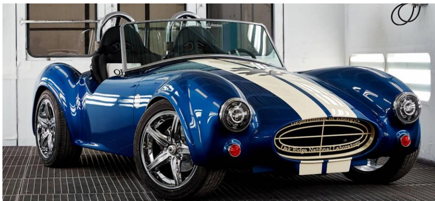
Figura I.6. Replica del Shelby Cobra realizada mediante impresión 3D
