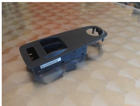
Figura III.2. a) Imagen de la pieza original de la carcasa del mando elevelunas, b) Imagen original de la carcasa del conmutador de luces del Peugeot 207
