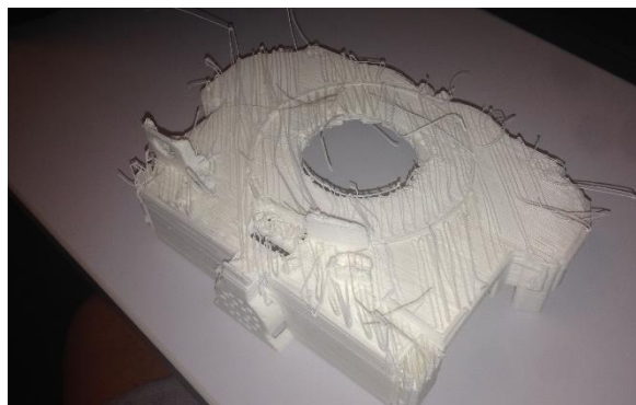
Figura III.21. Parte inferior de la carcasa antes del postprocesado
