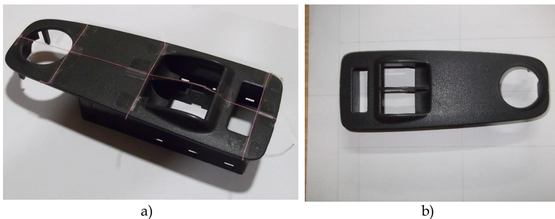
Figura III.3. a) Pieza con hilo para tomar referencias para la medición y dibujo, b) Vista de la pieza para insertarla en SolidWorks para dibujar el contorno exterior.
