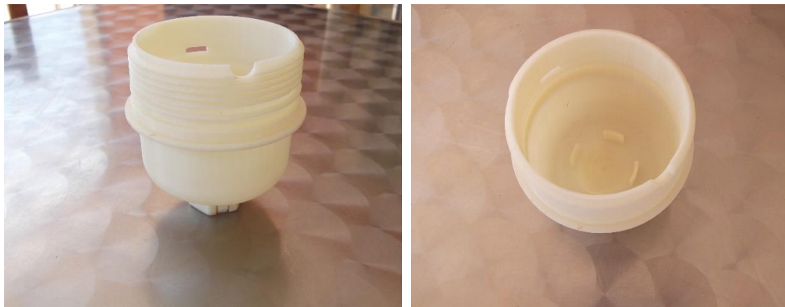
Figura III.14 a) Imagen exterior de la tapa realizada mediante la impresora 3D Dimension, b), c) Imagen de la parte interior de la carcasa realizada mediante la impresora 3D Dimension, d)
