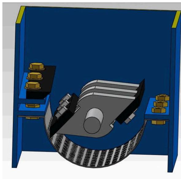
Figura 2 – Corte transversal de la trituradora estándar en el que podemos diferenciar la cuchilla fija, el árbol con las cuchillas móviles y la criba para filtrar el tamaño resultante de salida.
