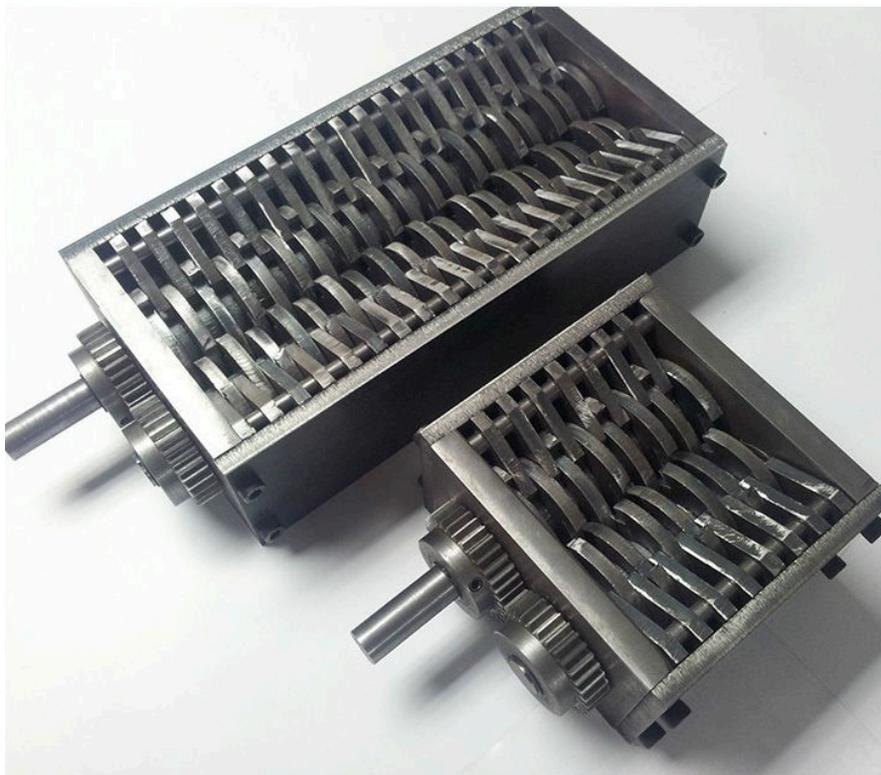
Figura 6 – Conjuntos de trituración de 2 árboles con un diferente número de cuchillas
