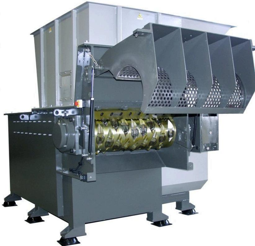
**Figura 3 - Molino mono árbol con cajón impulsor, con la criba de salida abierta en el que se puede observar el rodillo de cuchillas.**
