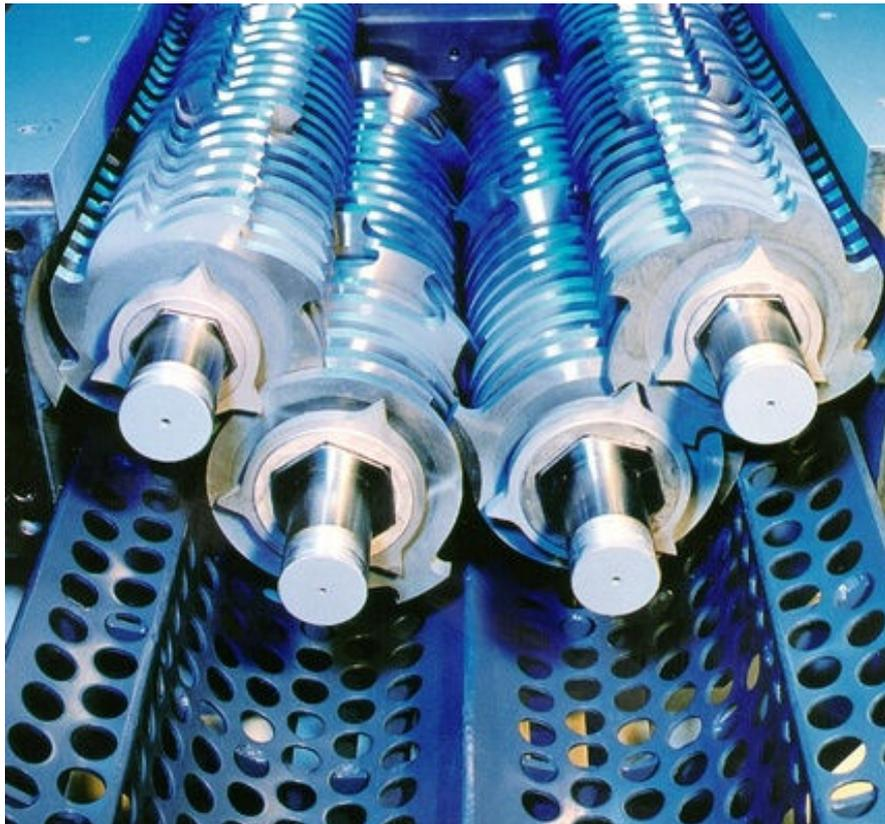
Figura 9 – Trituradora de 4 árboles con configuración de trituración de los 4 árboles.
