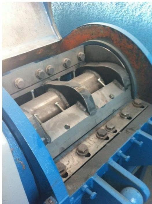
Figura 1 – Zona de trituración en la que se puede ver el árbol con las cuchillas móviles enfrentadas a la cuchilla fija.
