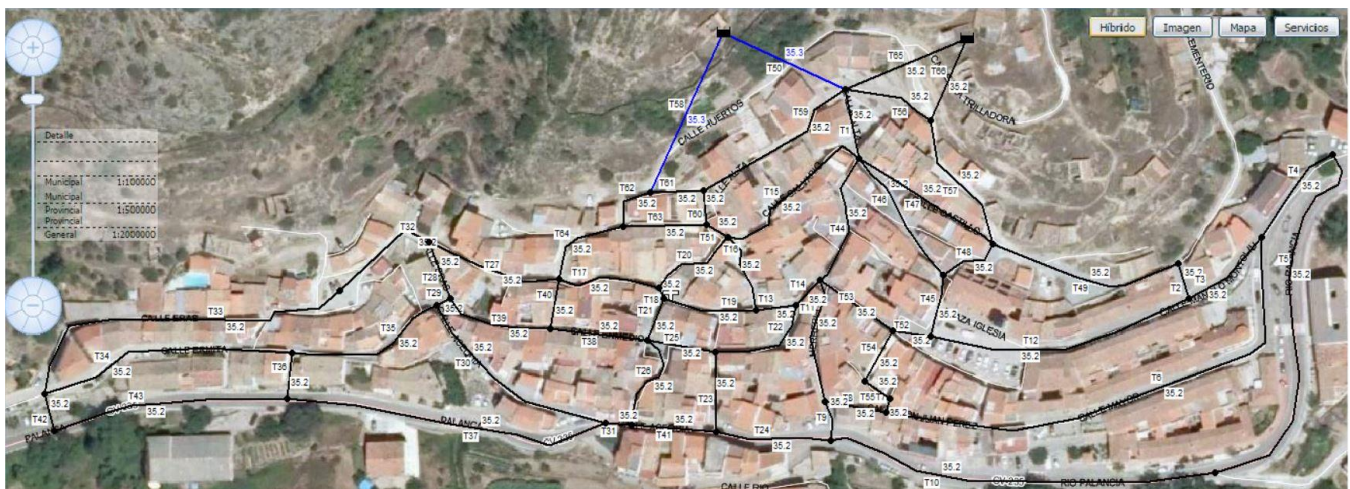
Plano 11.- Configuración de red nº1 (T58 y T50 cerradas)
