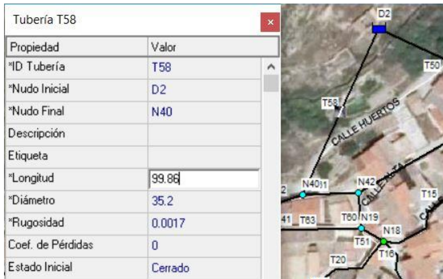
Foto 25.- Recorte Epanet: Modificación longitud tubería T58
