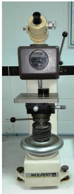
Fig. 18. Durómetro Wolpert V-Testor 2 utilizado para la determinación de la dureza del material.
