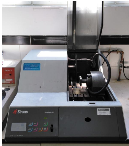
Fig. 12. Tronzadora de precisión STRUERS Secotom-10 utilizada durante el desarrollo del proyecto.
