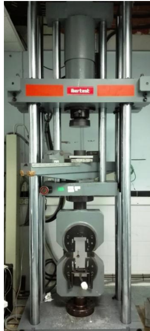
Fig. 17. Prensa universal de ensayos IBERTEST empleada en los ensayos de compresión.
