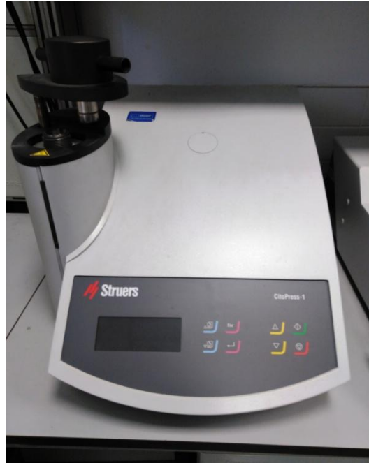
Fig. 13. Embutidora Struers CitroPress-1 empleada durante el desarrollo del proyecto.
