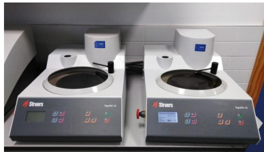
Fig. 14. De izquierda a derecha, pulidora y lijadora TegraPol-15, de la casa Struers.
