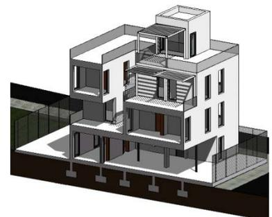
Figura 36. Modelo 3D Revit de la Casa 3x3 en Requena con un nivel de desarrollo de LOD 200. Fuente: Elaboración propia.
