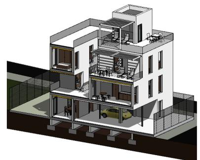
Figura 37. Modelo 3D Revit de la Casa 3x3 en Requena con un nivel de desarrollo de LOD 300. Fuente: Elaboración propia.
