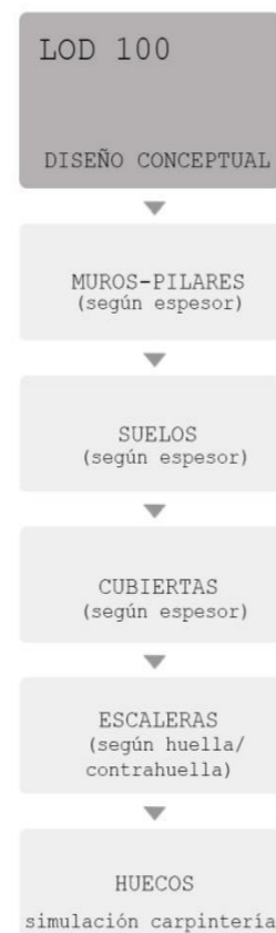
[FIG. 22]- PROCEDIMIENTO LOD 100. FUENTE: ELABORACIÓN PROPIA
