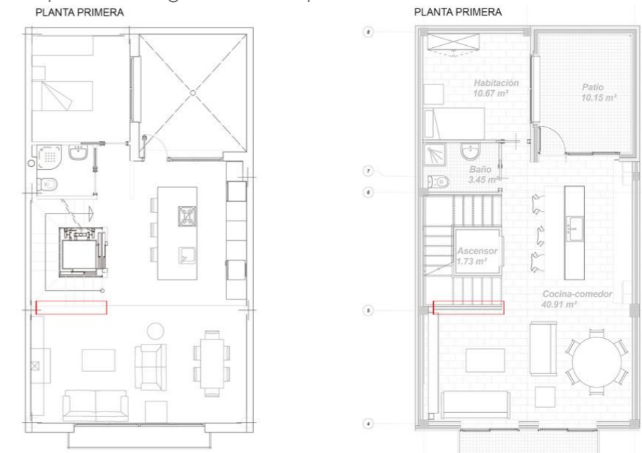
[FIG. 52]- DESARROLLO DEL PROYECTO. CREACIÓN TABIQUE ENRASADO EN ESCALERA. FUENTE: JOSE ANTONIO JIMÉNEZ CARRERA. ARQUITECTO VIVIENDA UNIFAMILIAR
