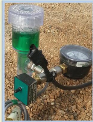
Figura 1. Sensores evaluados. Tensiómetros y sondas EasyAG®.
