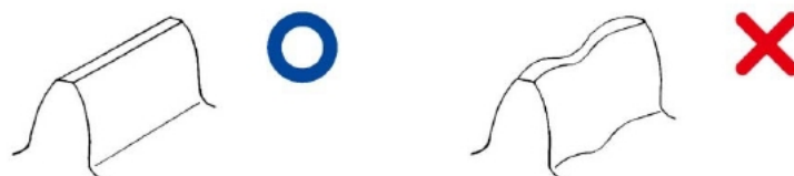
Imagen 2.3: Error de la línea de flanco (fuente:KHK)
