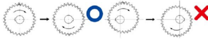
Imagen 2.4: Error de excentricidad con el eje de giro (fuente:KHK)
