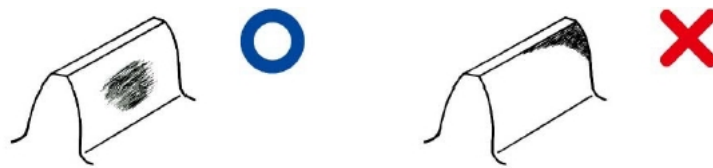
Imagen 2.5: Contacto correcto del diente (fuente:KHK)
