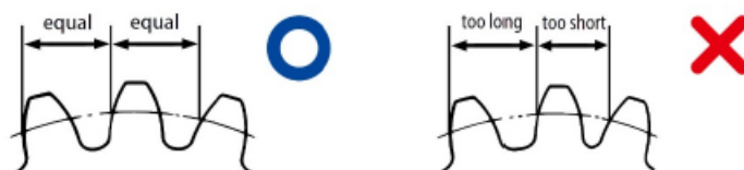
Imagen 2.1: Error de paso de diente (fuente:KHK)
