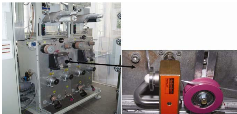
Figura 16: Texturizadora por aire capaz de producir hilo híbrido (izquierda) y detalle de la tobera de aire (derecha)
