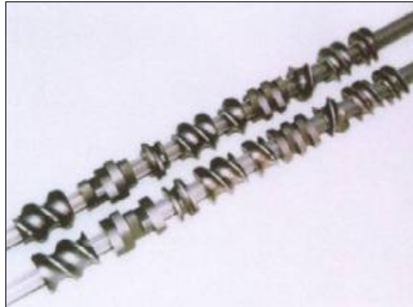
Figura 23: Elementos de un husillo ensamblados en un eje metálico.
