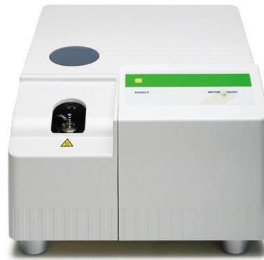
Figura 20. Equipo Analizador Calorimétrico Mettler Toledo DSC 822®.
