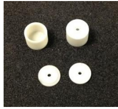
Figura 17. Crisoles y tapas de alúmina de 70 \mu l para ensayos TGA.
