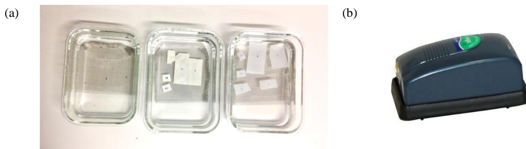
Figura 15. (a) Recipientes de vidrio con malla de acero inoxidable en la base y sobre ella las muestras y (b) Compresor de aire aquarium MGZ-548®.
