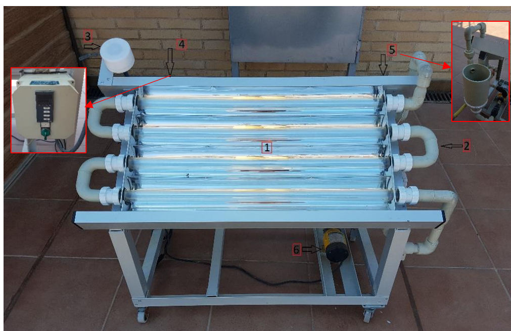
Figura 3.2.3 – Planta piloto de fotocátalisis solar de 4 L. Imágenes incrustadas: [4] Cuadro de mandos y [5] depósito.
