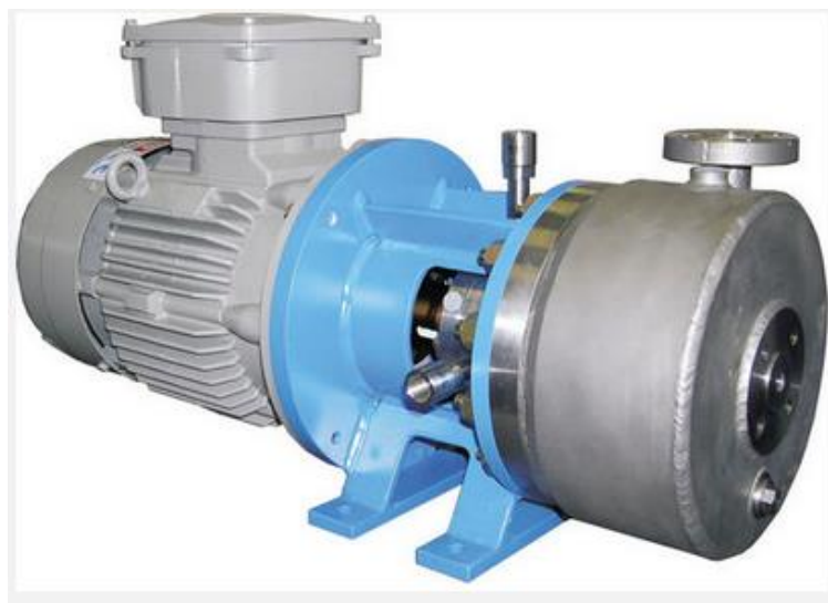
Figura 4.3.1.1.3 – Bomba utilizada en la planta de fotocátalisis
