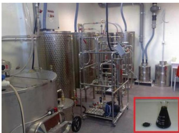
Figura 3.1.2.1 – Planta piloto para la obtención de SBO. Imagen incrustada: SBO en polvo y su disolución en agua (Gomis J, 2015)
