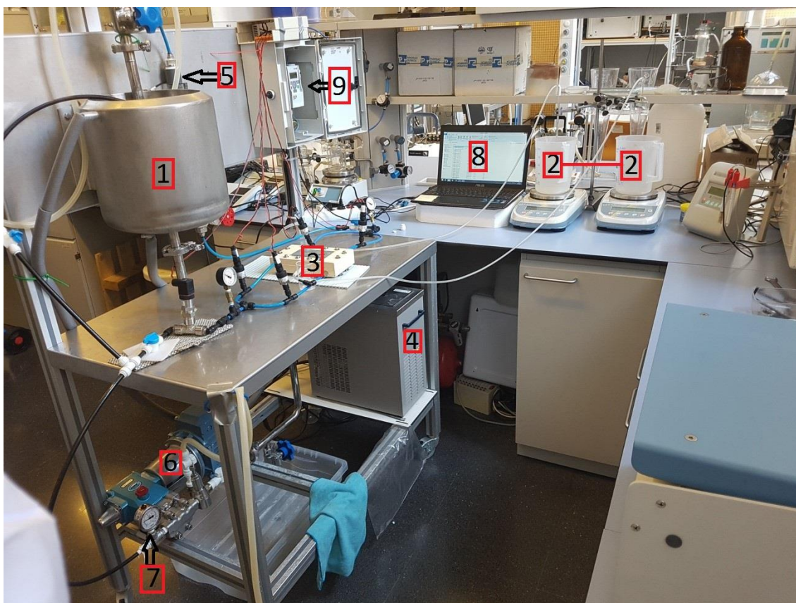
Figura 3.2.1 – Planta de ultrafiltración de membranas poliméricas
