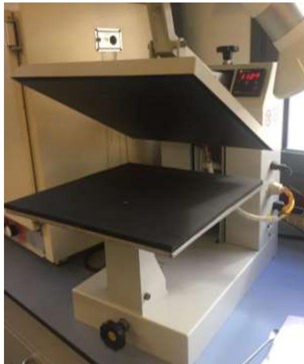
Imagen 4. Plancha normalizada para realizar el ensayo.
