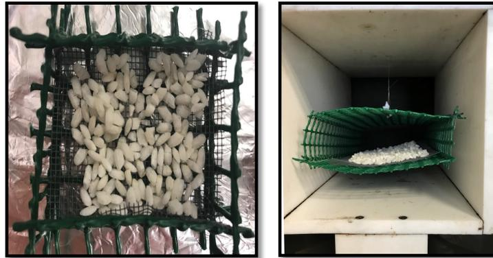
**Figura 2.** Disposición de la muestra en la cámara de secado
