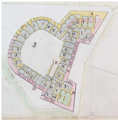
Fig. 5- Planta del fuerte de San Fernando que se está construyendo en el canal de Bocachica, 1753, por Lorenzo de Solís. Archivo General de la Nación (Colombia), Map. 4, Ref. 402-A.
