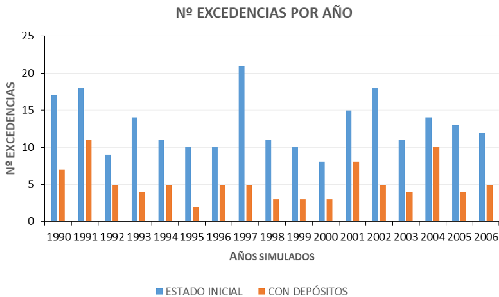
Fig. 37. Comparativa entre los vertidos aliviados antes y después de implantar los depósitos.
