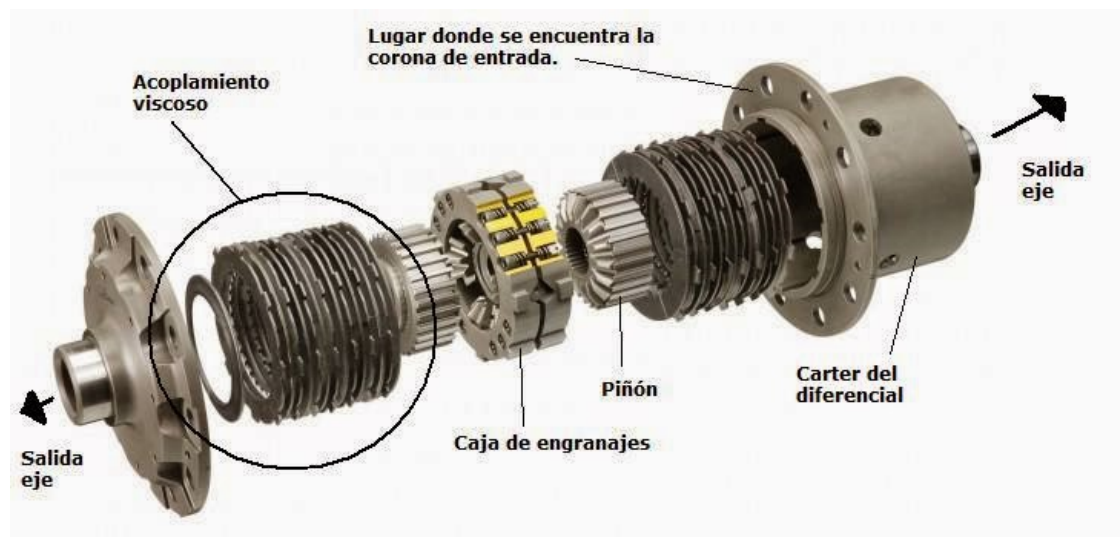
Imagen 10. Diferencial de deslizamiento limitado de discos.
