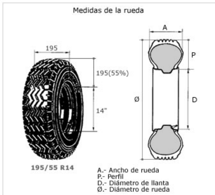
Imagen 19. Esquema de las medidas de un neumático.
