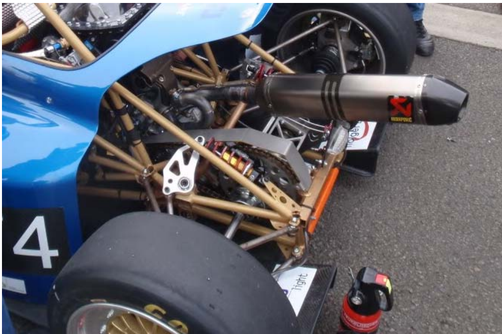
Imagen 4. Detalle de la transmisión por cadena de rodillos de un Formula Student.
