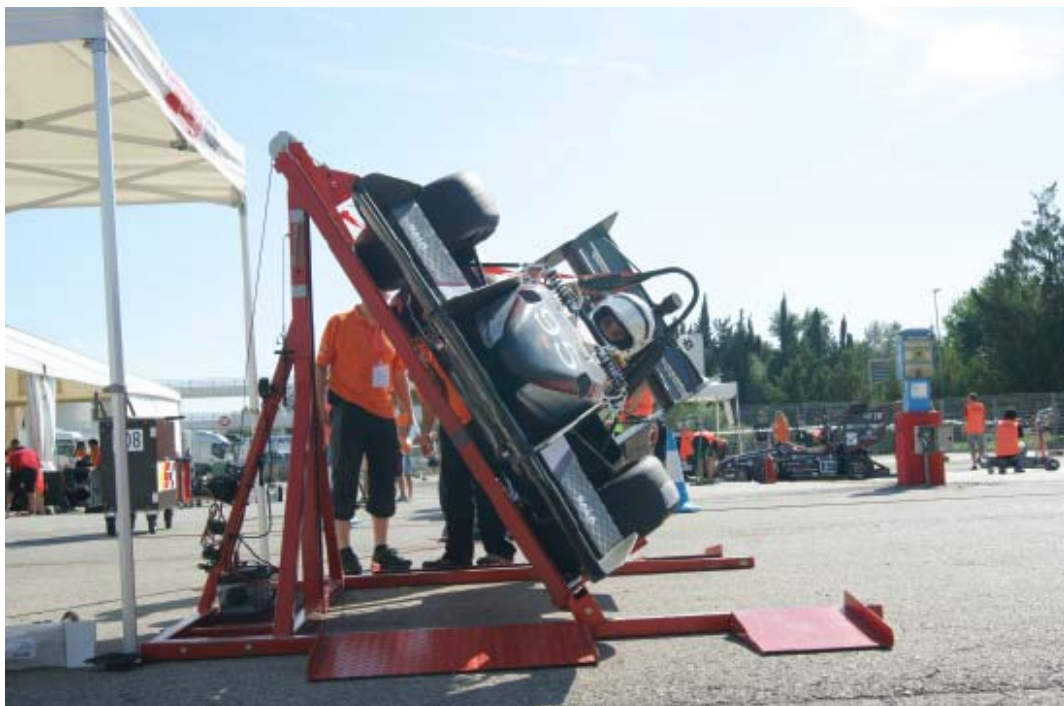
Imagen 3. Verificación de fugas en inclinación de 45° en las pruebas estáticas.
