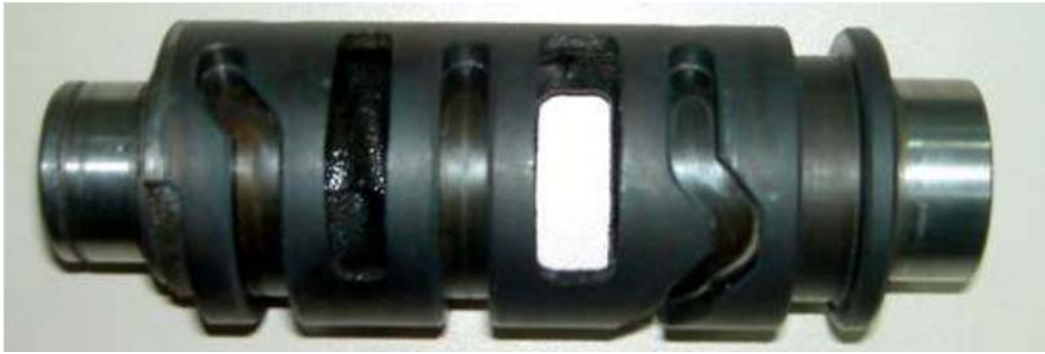
Imagen 16. Cilindro desmodrómico de una caja de cambios de motocicleta.
